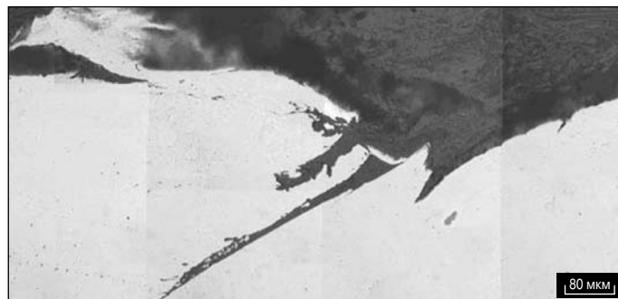
Рис. 3. Панорамное изображение дефекта «белая полоса с надрывом» с глубокими клинообразными надрывами (×500)
