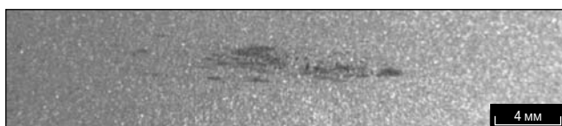
Рис. 6. Внешний вид дефекта «черные штрихи»
