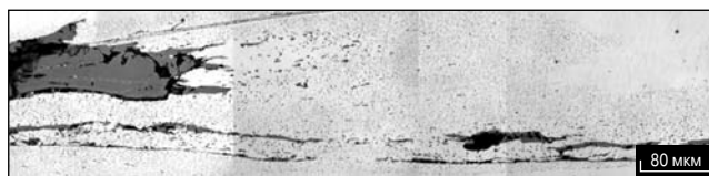
Рис. 3. Сателлитные включения в дефектных образцах горячекатаного подката (×500)
