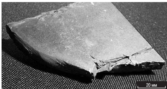
Рис. 6. Внешний вид дефекта «слиточная рванина»
