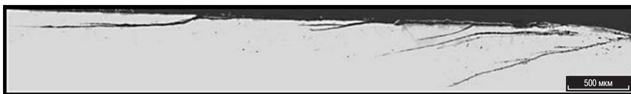
Рис. 7. Панорамное изображение дефекта «слиточная рванина» на поперечном нетравленном шлифе
