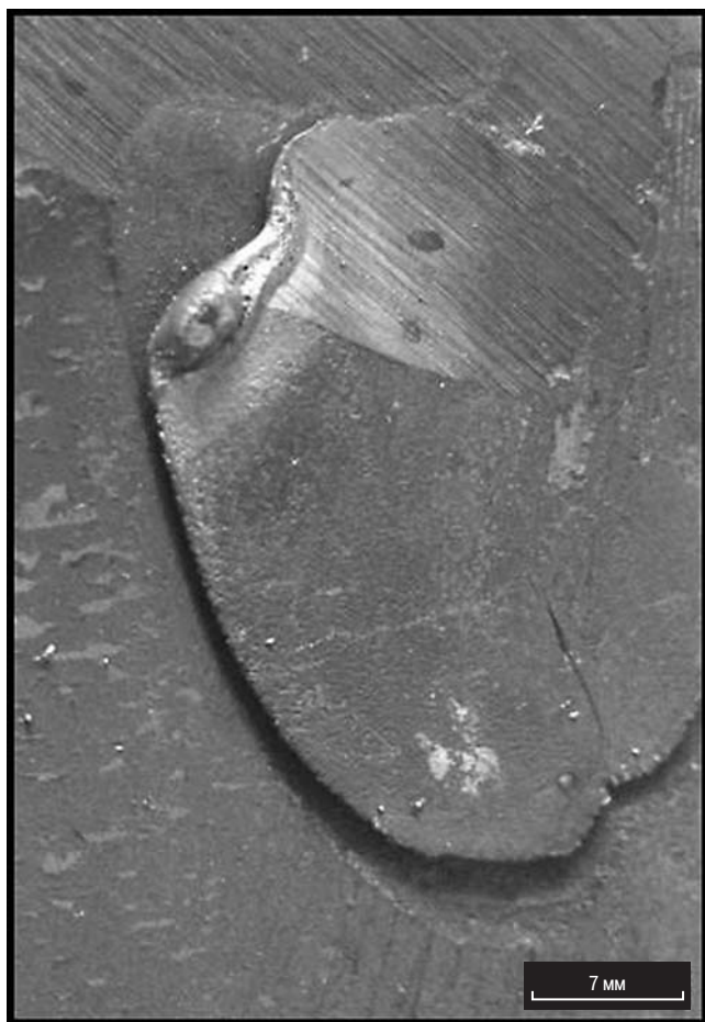
Рис. 3. Внешний вид дефекта «пленка»
