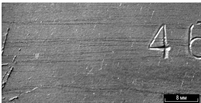
Рис. 1. Внешний вид дефекта «закат» (старое название «волосовина»)
