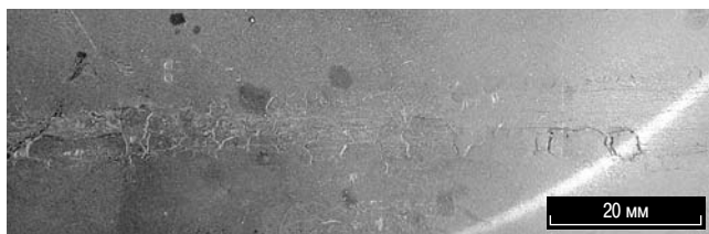
Рис. 6. Внешний вид дефекта «прокатная плена»
