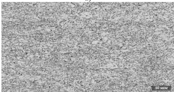
Рис 12. Поверхность излома образца после ИПГ (а) и соответствующая ему микроструктура бейнита (б) (поперечное сечение).
