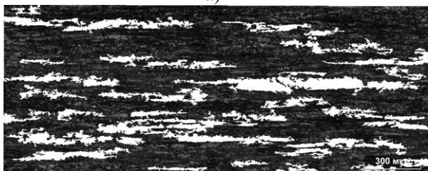
Рис. 10. Панорамное изображение структуры после цветного травления при увеличении \times 200 в поляризованном свете (а) и распознанная структура на анализаторе изображения Thixomet (б).
