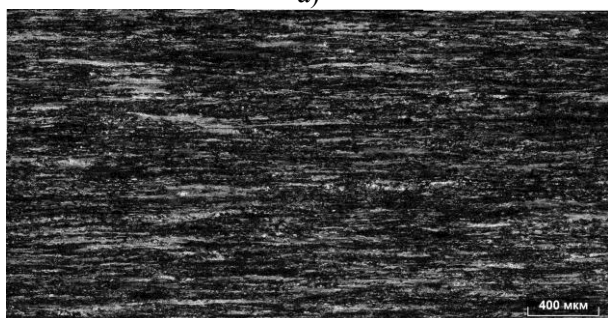
Рис. 9. Панорамное изображение структуры после цветного травления при увеличении \times 100 в светлом поле (а) и в поляризованном свете (б).
