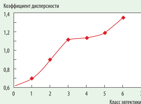
Рис. 2. Соответствие класса Al – Si-эвтектики (согласно AFS) коэффициенту дисперсности
