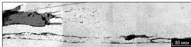
Рис. 3. Сателлитные включения в дефектных образцах горячекатаного подката (×500)
