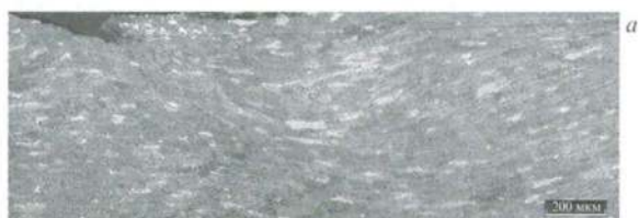
Рис. 13. Панорамное изображение дефекта "белая полоса с надрывом" с глубокими клинообразными надрывами ( \times 500 )
