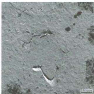
Рис. 7. Фрагмент поверхности дефекта “белая полоса без надрыва”; электронный микроскоп (×200)
