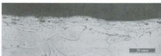
Рис. 6. Микроструктура дефекта "белая полоса без надрыва"; образец после травления; панорама создана вертикальной склейкой расфокусированных изображений (x1000)
