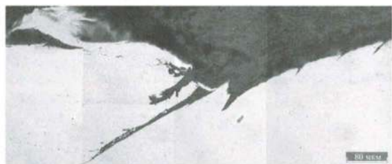
Рис. 13. Панорамное изображение дефекта "белая полоса с надрывом" с глубокими клинообразными надрывами ( \times 500 )
