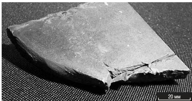
Рис. 6. Внешний вид дефекта «слиточная рванина»
