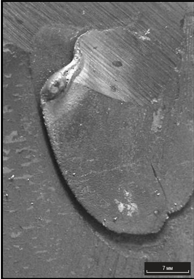
Рис. 3. Внешний вид дефекта «пленна»
