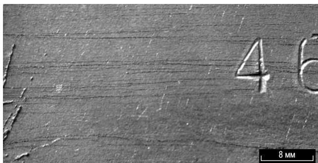
Рис. 1. Внешний вид дефекта «закат» (старое название «волосовина»)
