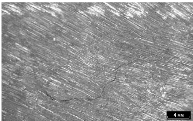
Рис. 8. Внешний вид дефекта «закат» из-за глубоких следов зачистки
