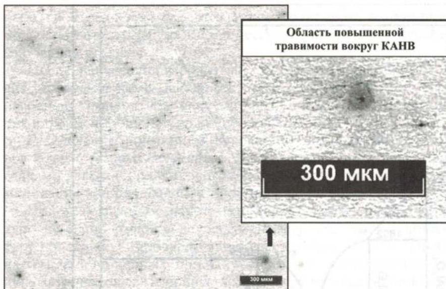
Рис. 9. Поверхность микрошлифа стали категории прочности К60 после обработки реактивами для определения КАНВ (загрязненность КАНВ — 0,67 вкл./мм<sup>2</sup>)
